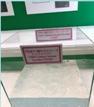
化学的処理によって作られたセルロースナノファイバー (ナノセルロースフォーラム展示品)
