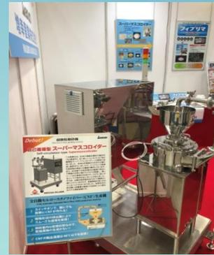
セルロースナノファイバーをターゲットに開発した新マスコロイダー。『自己循環式スーパーマスコロイダー』
