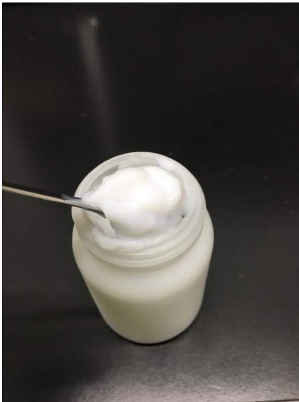
写真 3: 解繊後の CNF。水を含んだペースト状をしています。この状態で固形分はわずかに 3%しか入っていません。残りは全て水です。
